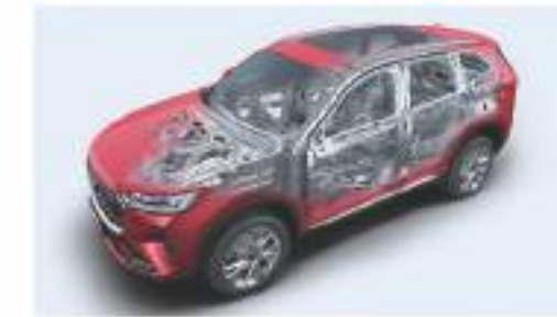
Каркас, на 72% выполненный из высокопрочной стали
