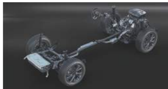
Передняя подвеска: макферсон, задняя подвеска: многорычажная независимая + полный привод
